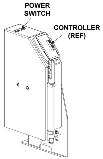
**TURNING POWER SWITCH ON/OFF** (LH PUMP SHOWN) FIG. 53-3
